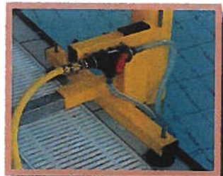
Robinetterie avec vanne 3 voies.
